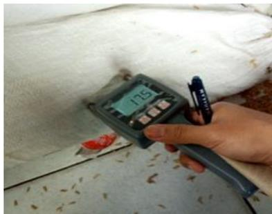
**Gambar 5. Pengukuran tingkat kadar air gabah**
