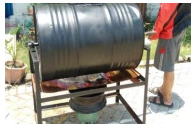
**Gambar 7. Pengukuran tingkat kadar air gabah dengan biomassa dan matahari**
