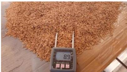
**Gambar 6. Pengukuran tingkat kadar air gabah pada box pengering**
