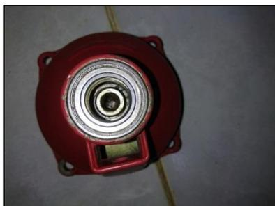
Gambar 4. *Clutch* Mesin
